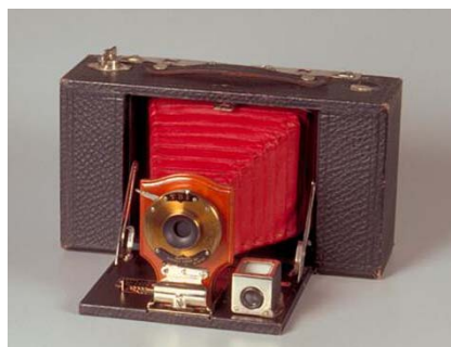
Obr. 05/ Kodak Folding Brownie 3 Model A, na svitkový film pro 12, 6 nebo 2 dvojité snímky obrazového pole 8x10,5cm. Čočka s achromatickou korekcí, rychlá závěrka, posuvné ostření s automatickým zámek, jednoduchý výtah. Hledáček reflexní, matnicový, otočný. Rozměry: 210 x 120 x 65 mm. Výroba od roku 1905.
