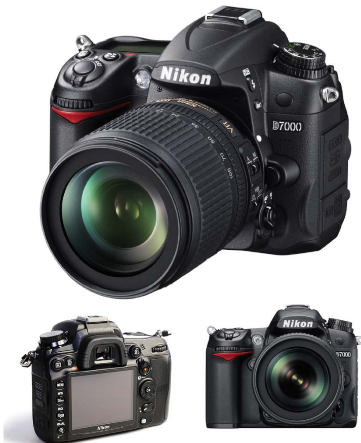
Obr. 26/ Nikon D 7000, digitální jednooká zrcadlovka formátu DX, obrazovým snímač CMOS-16,2 milionů pixelů zpracování obrazu EXPEED 2, široký rozsah citlivosti ISO 100-6400, dva sloty pro paměťové karty SD, 39 zaostřovacích polí, funkce pro záznam videosekvencí D-Movie.
