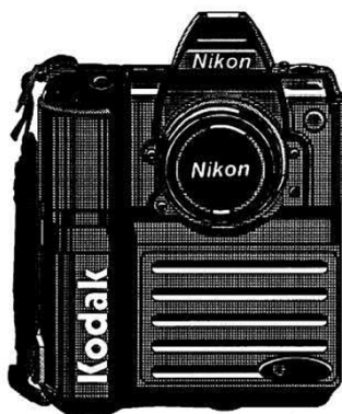
Obr. 19/ Kodak DCS 200, přístroj digitální, snímací čip CCD 1.54 Mpx umožňoval pořídit snímky o velikosti 1524 x 1012 px, Záznam probíhal vestavěný pevný disk 80MB, kde bylo možno uložit 50 snímků o velikosti 4,5Mpx. Pro zobrazení pořízených snímků se obsah pevného disku připojil na mikropočítač pomocí integrovaného rozhraní SCSI. Snímky se mohly za s sebou fotografovat každé 2,5 s. Baterie měla kapacitu pro 100 záběrů. Výroba v r. 1992/ 1993
