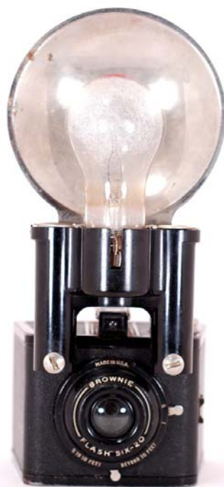
Obr. 08/ Kodak Six-20 Flash Brownie, pro svitkový film 120, vestavěný hledáček, rotační závěrka s rychlostmi I, B, rozsah ostření bylo možné nastavit 5 , 10 stop nebo nekonečno. Výroba v letech 1940-1946
