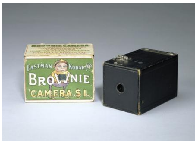
Obr. 03/ Kodak Brownie camera na svitkový film typu 117, 1. Brownie fotoaparát, jednoduchá čočka ve tvaru menisku, závěrka s časy 1/35 a 1/50 Výroba od r. 1900.
