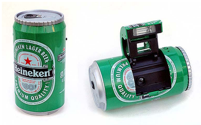
Obr. 40/ Ginfax Can Camera (Heineken), tato 35mm kamera byla vyrobena v designu plechovky různých značek piva a sody. Vznikla i varianta v podobě nadměrné baterie nebo filmové kazety.
