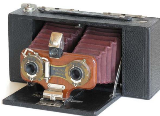
Obr. 04/ Kodak Brownie Stereo vybaven dvěma menisky s achromatickou korekcí a automatickou vzduchovou závěrkou Výroba od roku 1905.
