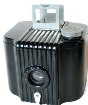
Obr. 07/ Kodak Baby Brownie, přístroj skříňkový na svitkový film 127 pro 8 snímků obrazového pole 4 x 6,5 cm. Objektiv meniskus, závěrka pérová pro časové a momentní expozice. Hledáček rámečkový, zmenšený. Rozměry: 80 x 70 x 60 mm Výroba od r. 1935
