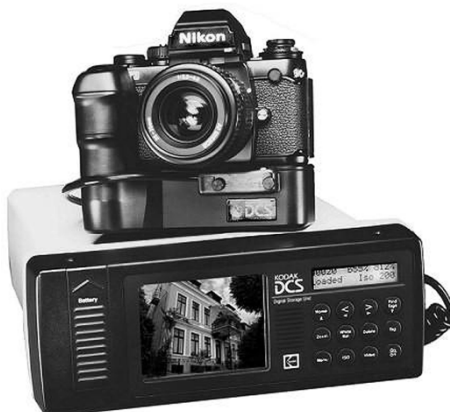
Obr. 18/ Kodak DCS 100, tělo Nikonu upravené motorovou jednotkou MD4, pevný disk měl 200 mb, který mohl uložit až 156 snímků bez komprese, nebo až 600 snímků s použitím JPEG, energii zajišťoval dobíjecí akumulátor nebo 12 V AC adaptér. Možnost připojení k počítači přes externí rozhraní SCSI. Výroba v r. 1991
