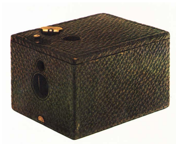
Obr. 02/ Kodak Pocket camera, přístroj skříňkový na svitkový film pro 12 snímků obrazového pole 4 x 5 cm. Objektiv meniskový, závěrka momentní sektorová. Hledáček reflexní, matnicový. Jde o první přístroj na svitkový film krytý černým papírovým pásem.
