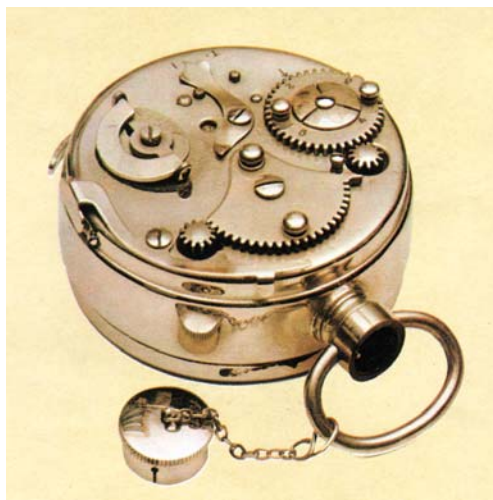
Obr. 33/ Přístroj maskovaný, celokovový, zn.: TICKA, mající design kapesních hodinek. Objektiv umístěný v natahování hodinek, pevné zaostření (fix-focus). Kamera pracuje na svitkový film ve speciální kazetě pro 25 snímků ve formátu 16 x 22 mm.
