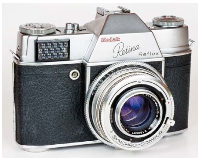
Obr. 11/ Kodak Retina Reflex (typ 025) přístroj zrcadlový, výměnné objektivy s dálkoměrem v rozsahu 35, 50 a 80 mm, závěrka Compur od společnosti Deckel. Vyrobeno ve Stuttgartu, Kodak company, Výroba v letech 1957-1958
